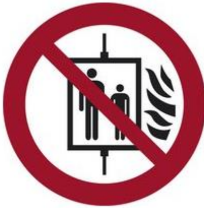
P020 Aufzug im Brandfall nicht benutzen
